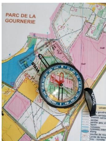
2. Mettre le nord de la boussole comme le nord de la carte. Sans bouger, tourner le cadran pour mettre le « N » vers le haut, les traits bleus du fond de carte doivent être parallèles aux traits rouges et noirs de la boussole.
