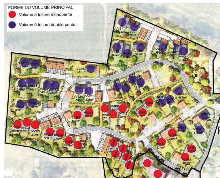
Figure 2 : Répartition attendue de toitures au sein du nouveau quartier
